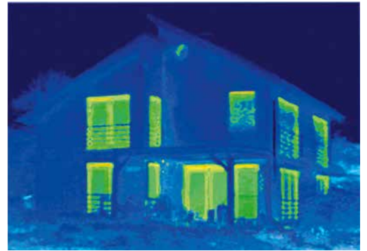
Nach dem sorgfältigen Einbau neuer Fenster aus dem Schüco LivIng Alu Inside Fenstersystem beweist die Thermografie den hohen energetischen Nutzen der Investition. Der ursprüngliche Energieverlust wird nahezu vollständig vermieden.
